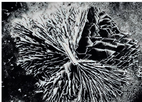
Krystaly \text{CaHZn} po 24 hodinách v \text{Ca}(\text{OH})_2 roztoku s pH 12,6
