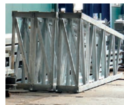
Dobře navržená a kvalitně pozinkovaná ocelová konstrukce – ilustrační obrázek
