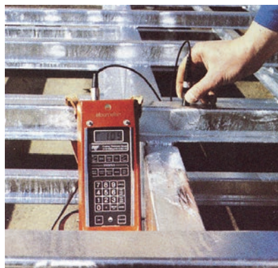
Obr. 9-1 – Měření tloušťky povlaku.
