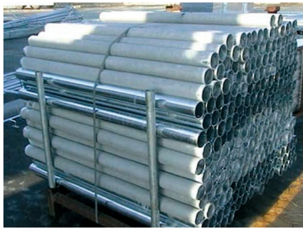
Obr. 5-7 – Žárově zinkované roury s různým obsahem křemíku. Některé jsou vyrobeny z oceli uklidněné hliníkem a získaly kovově lesklý povrch, zatímco jiné byly vyrobeny z oceli uklidněné křemíkem a získaly matný, šedý povrch.
