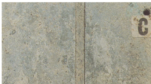
Obr. 10-10 – Stopa široká 6 mm, která se vyleptala v povlaku o tloušťce 60 µm až k povrchu oceli. Vzorek byl pět let exponován v náročném, průmyslově přímořském prostředí v Nizozemsku. Za povšimnutí stojí povlak zinečnatých solí ve stopě, stejně jako absence průniku rzi.
