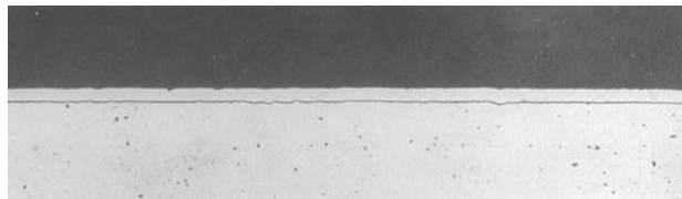
Obr. 3-1 – Řez elektrolyticky naneseným povlakem zinku.
