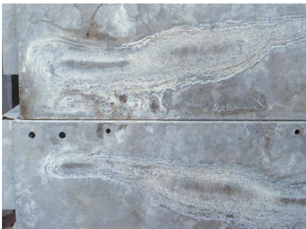
Obr. 10-2 – Bílá rez vytvořená mezi materiálem naskládaným na sebe.
